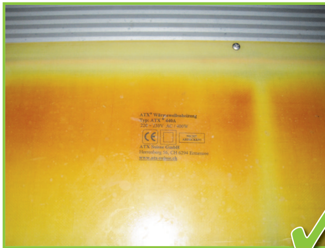
Im Dauergebrauch leicht verfärbtes, intaktes Heizelement.
