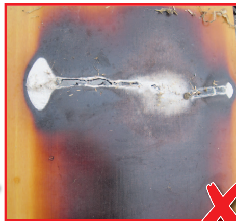
Glimmbrand wegen weiter Benutzung einer beschädigten Heizplatte!
